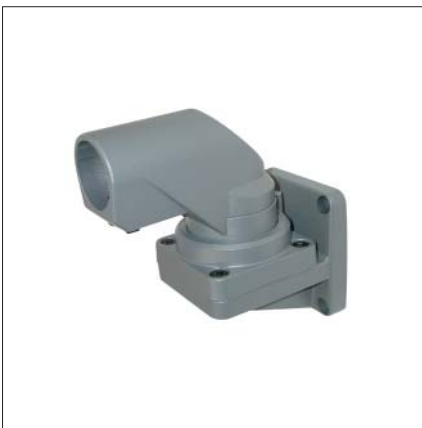
Wandgelenk W (waagrecht) Aluminiumguss mit Stahlinnenrohr und Gleitlager. Schwenkbereich 250° (nicht begrenzt, nicht arretierbar)
