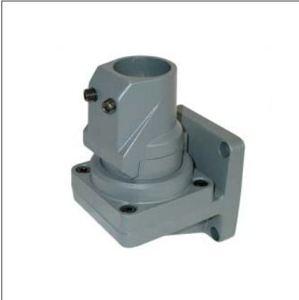
Wandgelenk S (senkrecht) Aluminiumguss mit Stahlinnenrohr und Gleitlager. Schwenkbereich 250° (nicht begrenzt, nicht arretierbar)
