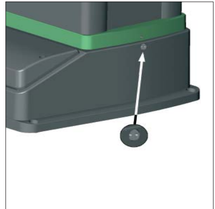
Sonderverschluss mit Steckschlüssel für Anschlussraum
